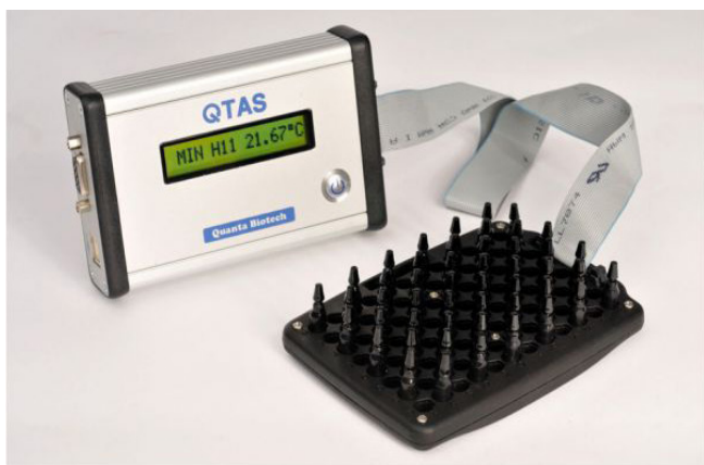
Måleprober monteret i interface. Måleenheden sættes direkte i PCR-blokken og måler præcist blokkens uniformitet.
